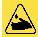
3012 G Etsende væske Corrosive
